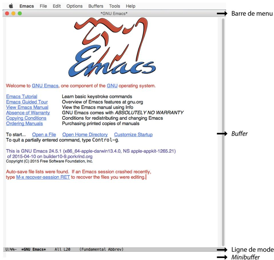
FIG. A.1 - Fenêtre GNU Emacs et ses différentes parties au lancement de l'application sous OS X. Sous Windows et Linux, la barre de menu se trouve à l'intérieur de la fenêtre.
